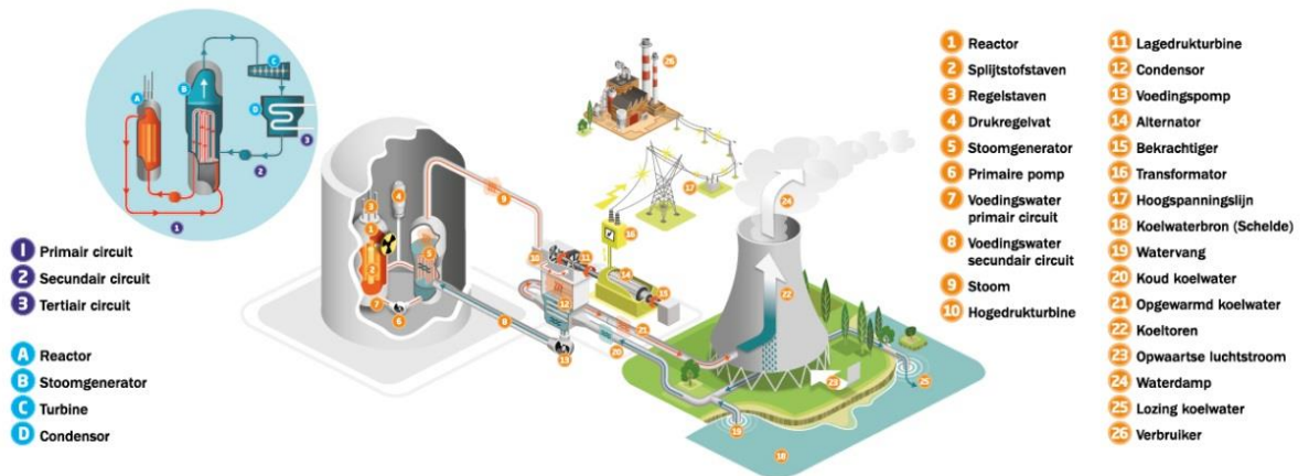
Figuur 8: Schematisch weergegeven werking van een kerncentrale
