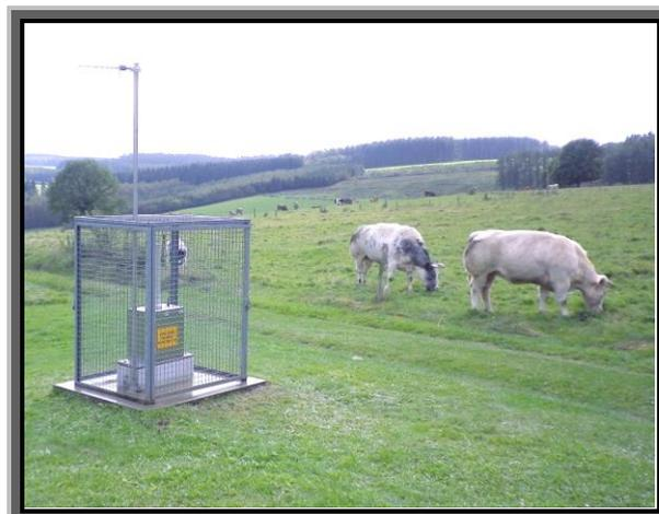
Figure 18 : Station de mesure des rayonnements gamma ambiants
