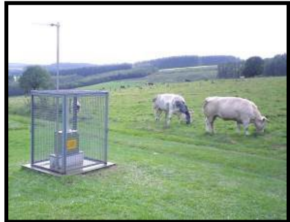
Figuur 22: Meetstation voor de gammaomgevingsstraling
