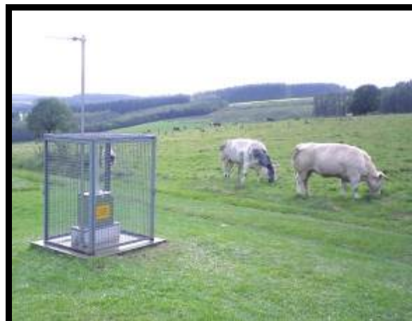
Figuur 22: Meetstation voor de gammaomgevingsstraling
