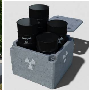
Figuur 2-4: IPM met illustratie van vaten in een caisson die daarna tot een monoliet gecementeerd wordt.
