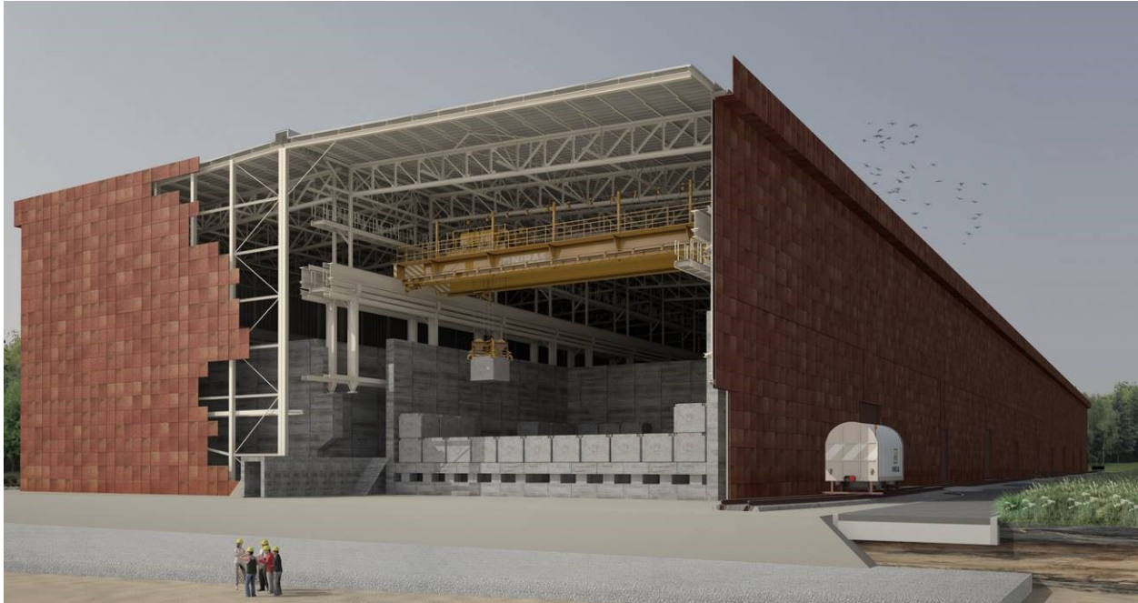
Figuur 2-5: Illustratie van bergingsmodules die onder een stalen dakstructuur worden geladen
