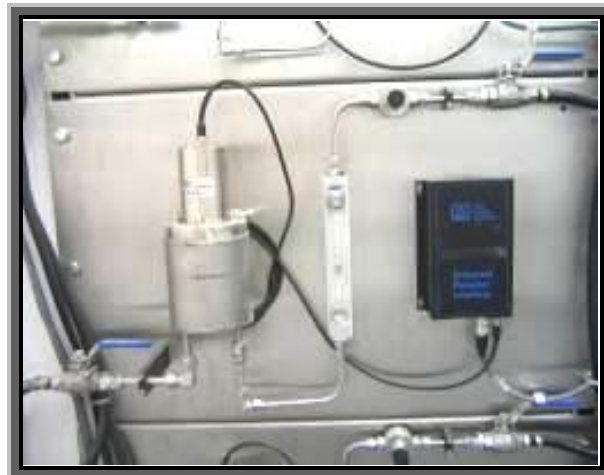
Figuur 13: Toestellen voor de permanente controle van de gasvormige lozingen in de inrichting Beta Plus Pharma te Brussel
