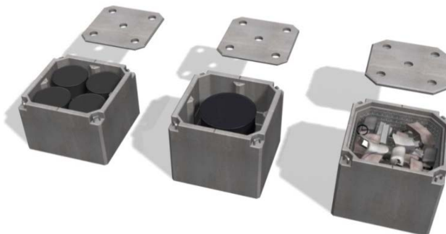
Figuur 7-1: Illustraties van de drie types caissons: type I (links), type II (midden) en type III (rechts) met afval
